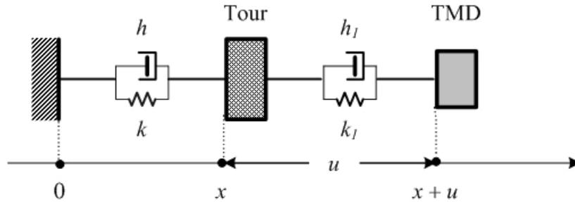
Fig. 1 : Principe simplifié du système TMD
