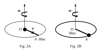
On appelle T(r) la tension de la barre au point P à une distance r de l'axe de rotation ; cette grandeur représente l'action du reste de la barre sur la longueur OP.
